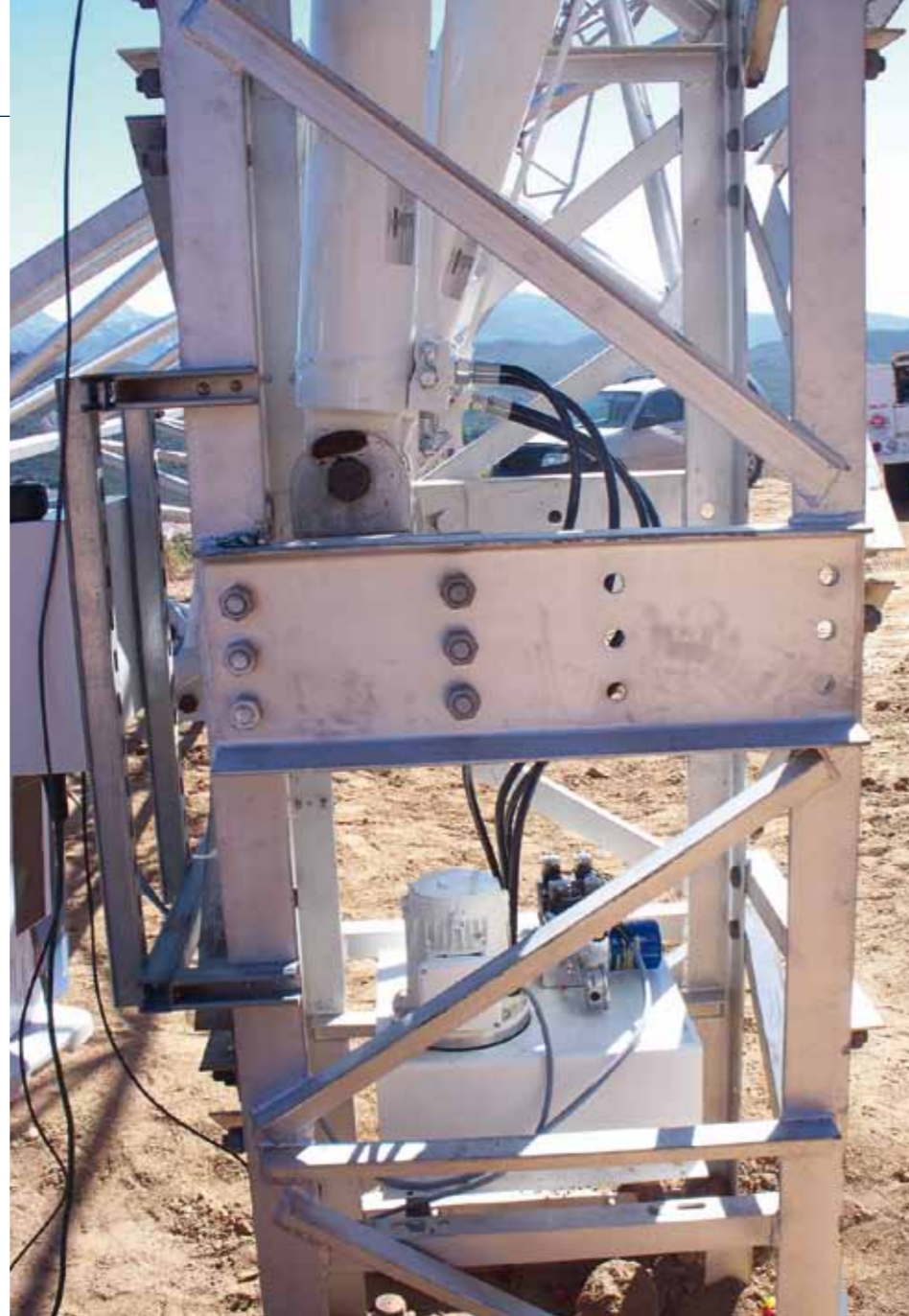
Die WEBER-HYDRAULIK-Gruppe liefert als Systemlieferant komplette Nachführungssysteme für solarthermische und photovoltaische Anlagen, bestehend aus Zylindern, hydraulischem Aggregat und elektrischer Steuerung.
