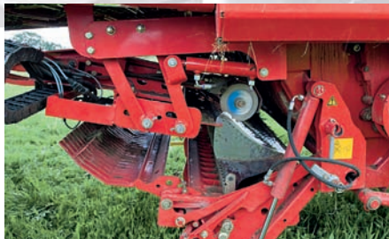
In Zusammenarbeit mit Pöttinger entwickelte Weber Hydraulik die Hydraulikanlage der preisgekrönten, automatischen Messerschleifeinrichtung des Jumbo Combiline Ladewagens.
