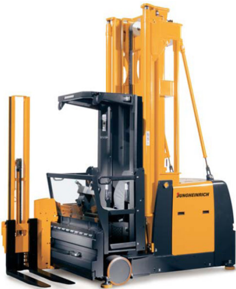
Abb. 2: Der neue EKX von Jungheinrich verfügt als erster Elektro-Kommissionierstapler über ein System zum Nutzsenken
